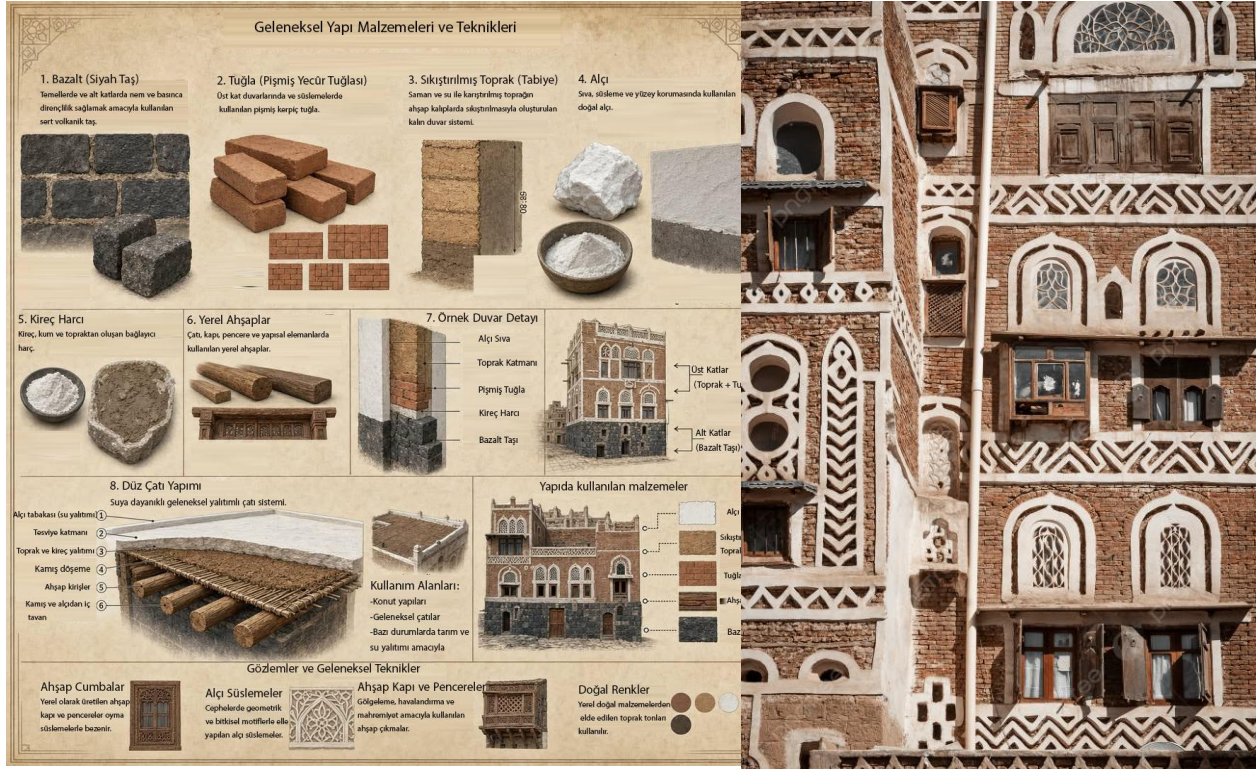
Şekil 8. Sana'a Eski Kenti'nde geleneksel mimariye ait yapı sistemleri, malzemeler ve çevresel uyum özellikleri.
