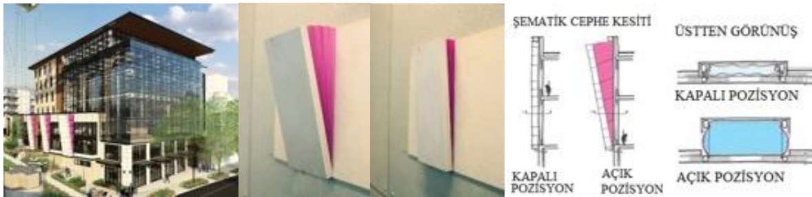
Şekil 27. Rain Bellow cephe elemanının prototipi ve çalışma mekanizmasının şematik gösterimleri (URL-24)
