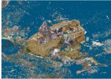
Şekil 62,63. Ctouts Manastırı İki Farklı İstasyondan Taranan Nokta Bulutlarının Register Edilmiş Görünüşü (Ş. Öztürk)
