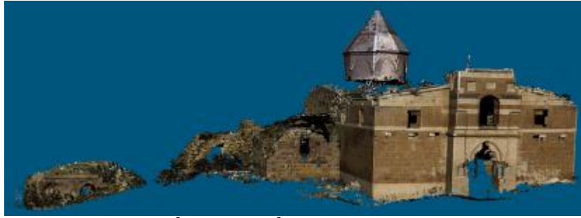
Şekil 66. Ctouts Manastırı İki Farklı İstasyondan Taranan Nokta Bulutlarının Register Edilmiş Görünüşü (Ş. Öztürk)
