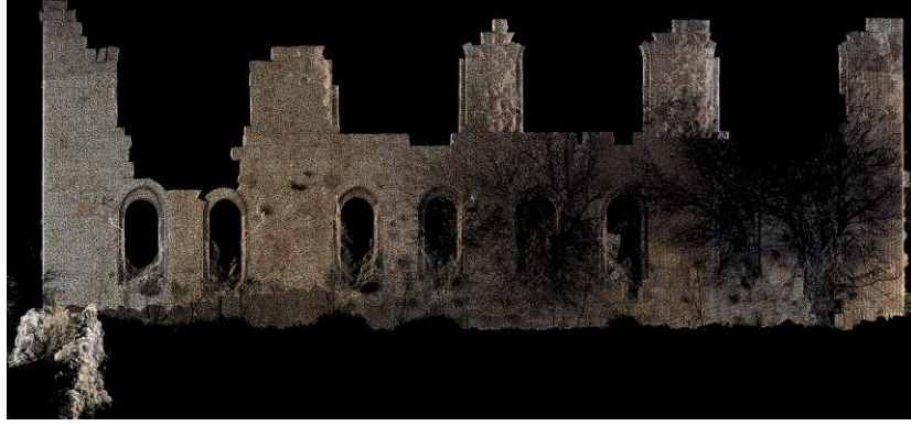
Şekil 45. Kayme Sarayı Lazer Tarama Nokta Bulutu Verisi (Ş. Öztürk)
