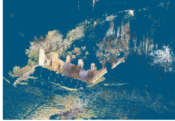
Şekil 43,44. Kayme Sarayı Trimble Gx 3d Scanner 3 Boyutlu Nokta Bulutu (Ş. Öztürk)
