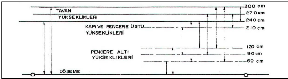
Şekil 1. Pencere ve parapet yükseklikleri (TS 6957, 1989).
