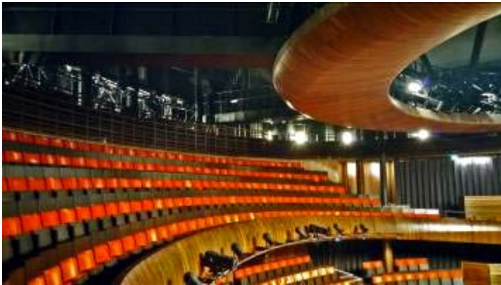
Şekil 32. Projektörlerin yerleştirildiği teknik birimler ile balkon ve sahne önü bölümündeki teknik kule (Mustafa KAVRAZ)
