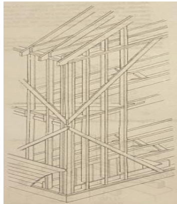
Şekil 3. Balloon Frame sistem kesiti (Türkçü, 2017)
