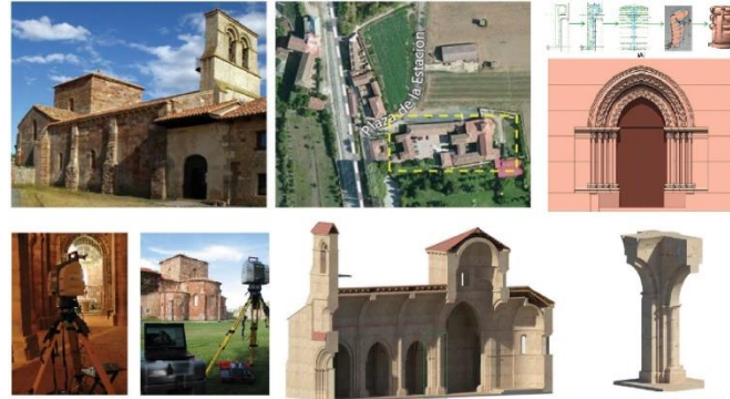
Şekil 15. Kültürel mirasın süsleme özelliklerinin ve detay profillerinin üç boyut modellemesi (López vd. 2017)
