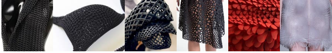
Şekil 11. Katmanlı üretim ile üretilmiş “Zincir-posta”, “Yaylı geçme”, “Mafsal”, “Menteşe” yapılı giyilebilir ürünler.
