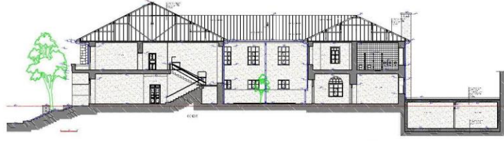
Çizim-22,23: Muş Eski Hükümet Konağı Rölöve-Retorasyon C-C Kesiti (Ş. Öztürk)
