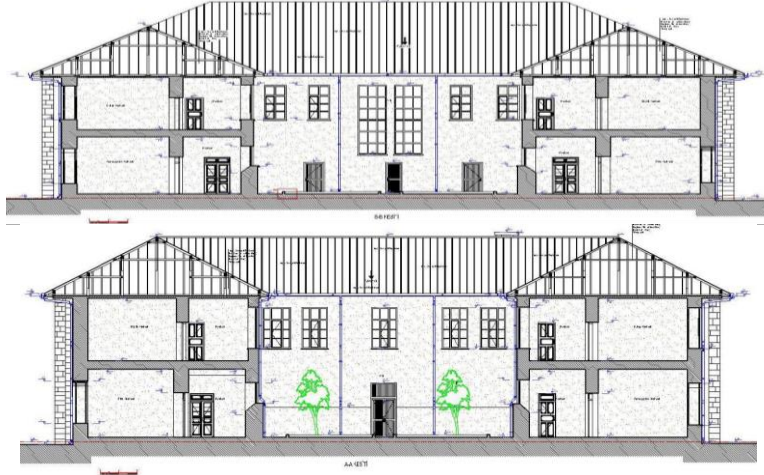
Çizim-18,19: Muş Eski Hükümet Konağı Rölöve-Retorasyon A-A Kesiti (Ş. Öztürk)
