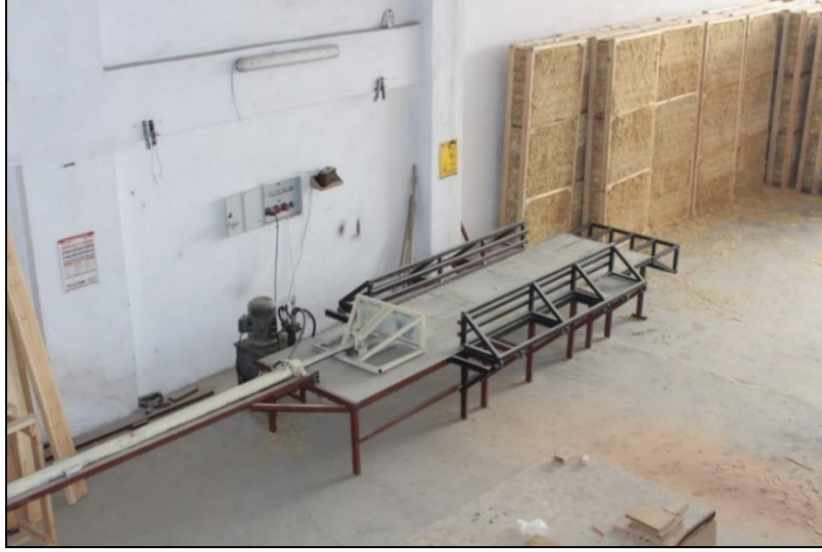
Şekil 3. Sıkıştırma makinesi ve modül üretim tezgâhı-2 [Duman:2020]
