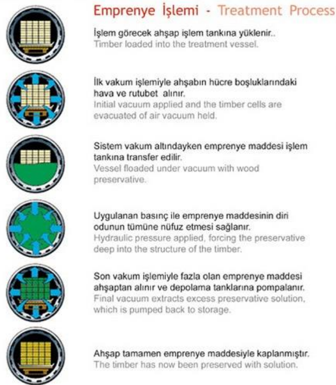
Şekil 1. Vakumlu Emprenyeleme işlemi infografiği ( Url-1 )
