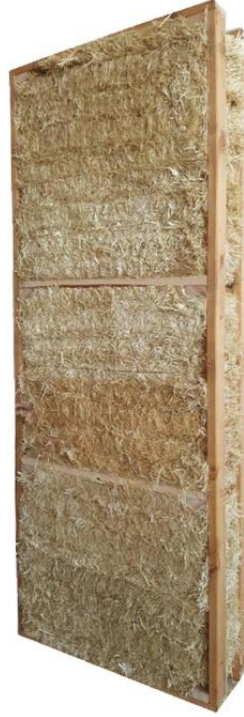
Şekil 5 Sıkıştırılmış balyalardan tasarlanan ve üretilen örnek modül [Duman:2020]
